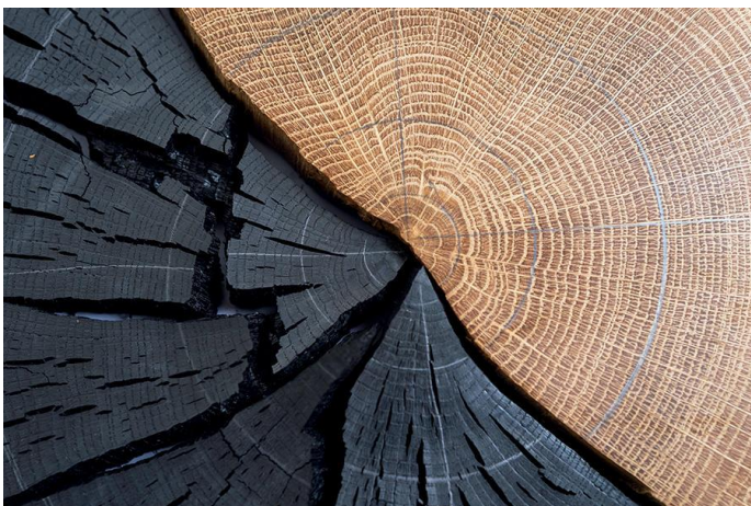
Bois de chêne similaire à ceux de la charpente de Notre-Dame. Une partie de la rondelle a ici été calcinée en laboratoire pour servir de modèle de comparaison.
