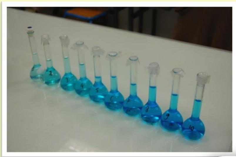
Nous avons dans des cuves identiques, une échelle de teintes à l'aide de solutions de sulfate de cuivre de concentrations croissantes de 0 à 100 g/L par paliers de 10 g/L.
