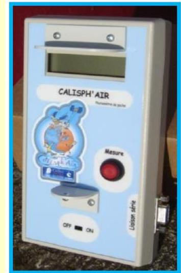
Cet instrument permet d'obtenir une grandeur, appelée épaisseur optique (sans unité), qui caractérise la transparence du milieu atmosphérique. Retenons que, plus la visibilité est réduite plus l'épaisseur optique sera importante. Considérons deux exemples extrêmes :
