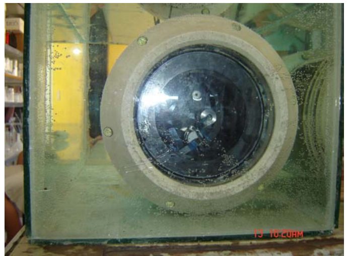
En test d'étanchéité
