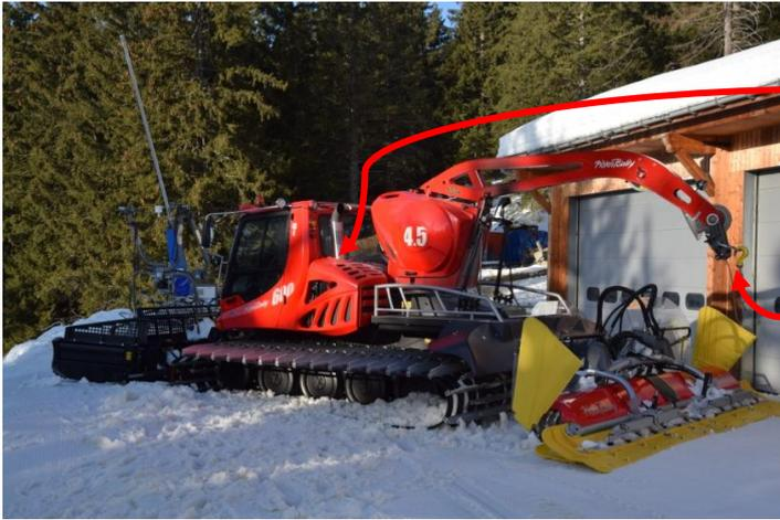
Les plus gros modèles de dameuses comme la **PistenBully 600** ci-contre, coûtent près de 450 000€, mesurent 10 m de long, pèsent 11 tonnes et sont constituées de 10 000 pièces détachées.
